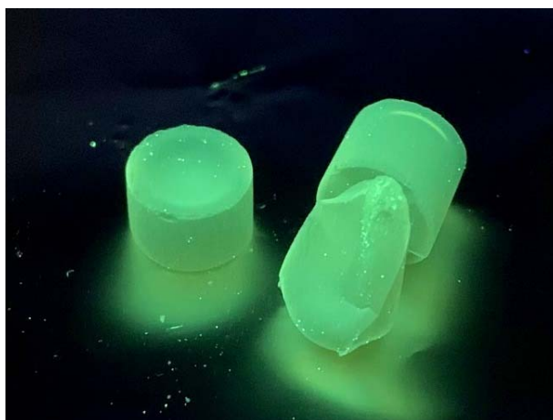
Рис. 1. Фотолюминесценция люминофорных материалов на основе аэрогелей при длине волны возбуждения 380 нм
